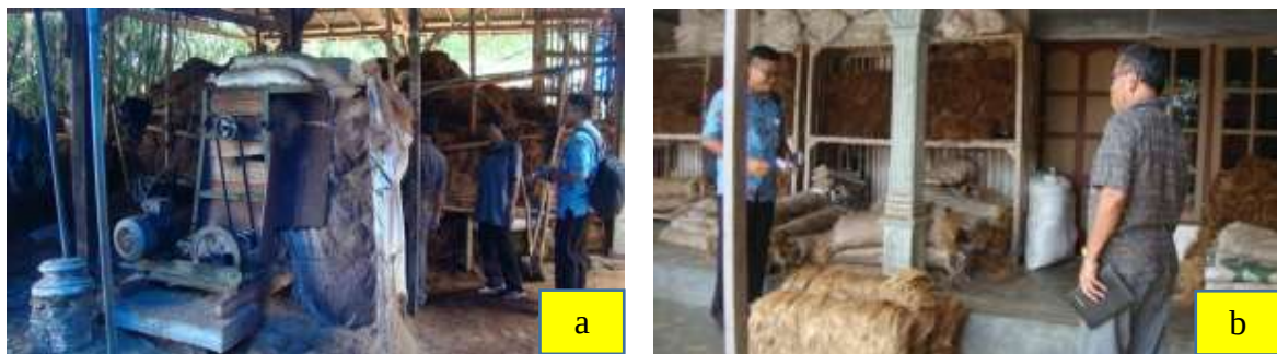
Gambar 85. a) Alat penyerat sabut kelapa, dan b) serat sabut kelapa
