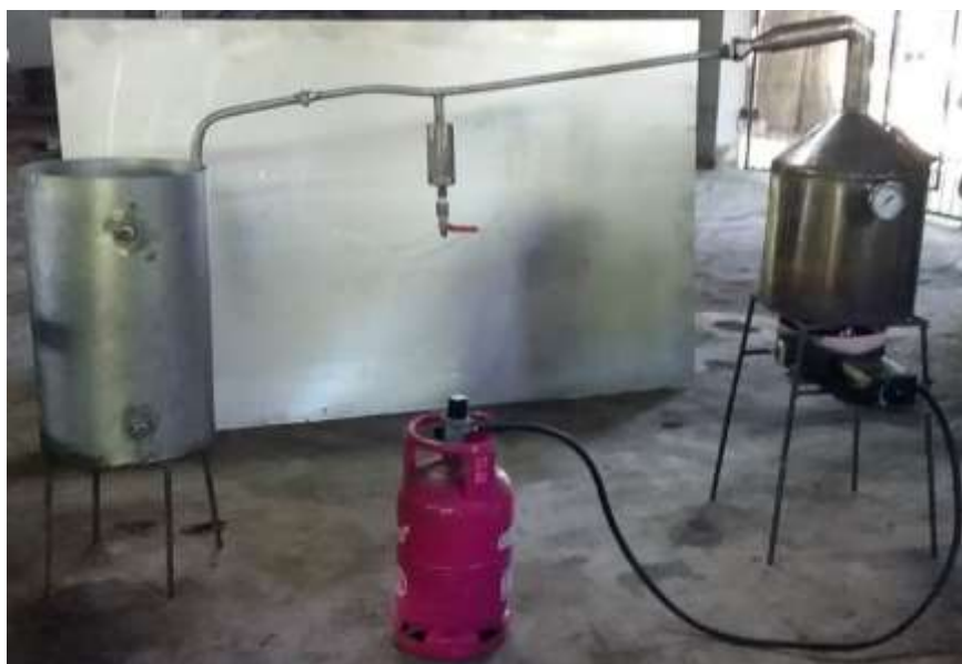
Gambar 87. Unit pengolahan asap cair
