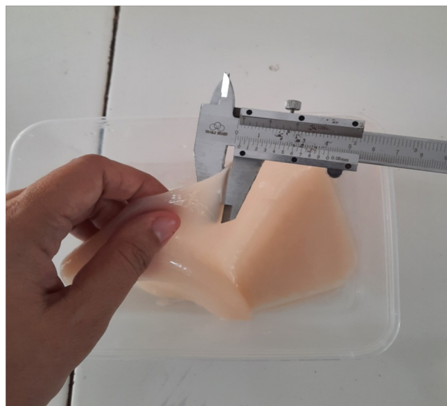
Gambar 6. Pengukuran ketebalan lembaran nata de coco menggunakan jangka sorong
